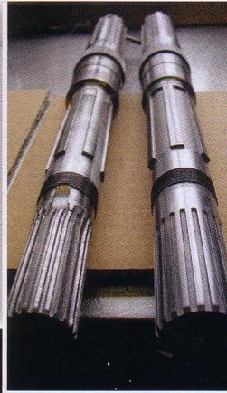
Von Hermann Oberlack revidiertes Ferrari 250 California-Getriebe (rechts). Das von einem Pleuel aus dem Motorblock herausgeschlagene Stück setzte er mit Laserschweißen ein (oben). Defekte und verstärkte Welle für einen Ferrari BB LM
